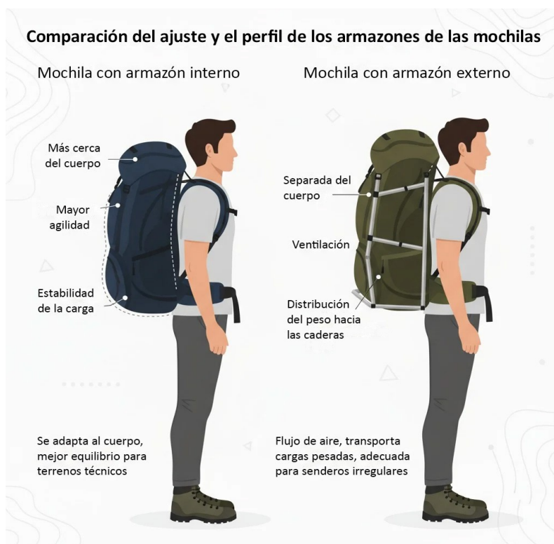
Imagen 2 - Comparación entre armazones internos y externos
